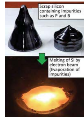
電子ビーム溶解法によるスクラップシリコンの再生 Recycling of scrap silicon using electron beam melting
