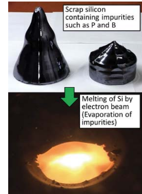
電子ビーム溶解法によるスクラップシリコンの再生 Recycling of scrap silicon using electron beam melting
