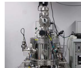
高温質量分析装置を利用した 材料製造プロセスのための反応解析 Reaction analysis of material production processes by high-temperature mass spectrometry
