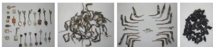
電気パルス粉碎によってICチップの単体分離された各種素材
